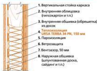
Сопротивление теплопередаче стены\* R = 3,85 м<sup>2</sup>К/Вт
