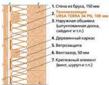
Сопротивление теплопередаче стены\* R = 3,4 м<sup>2</sup>К/Вт
