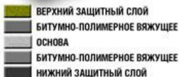
Унифлекс получают путем двустороннего нанесения на стекловолоконистую или полиэфирную основу битумно-полимерного вяжущего, состоящего из битума, СБС (стирол-бутадиен-стирол) полимерного модификатора и минерального наполнителя (тальк, доломит и др.). В качестве защитного слоя используют крупнозернистую, мелкозернистую посыпки, фольгу и полимерную пленку.
